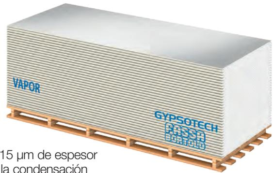
Placa en cuya parte trasera se ha encolado una lámina de aluminio de 15 µm de espesor que desempeña la función de barrera de vapor; sirve para impedir que la condensación de la humedad del aire dañe la placa con el tiempo.
