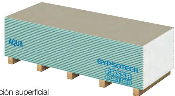
Placa de baja capacidad de absorción de agua (inferior al 10%) y absorción superficial (inferior a 220 g/m<sup>2</sup>) específica para ambientes con condiciones higrométricas particulares.
