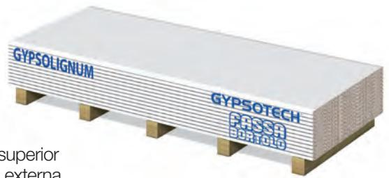
Placa especial diseñada para reunir varias particularidades; de densidad superior a 1000 kg/m<sup>3</sup>. GypsoLIGNUM esta constituida por una capa de celulosa externa de alta resistencia y una masa de yeso con aditivos especiales en el núcleo de yeso: fibra de vidrio, vermiculita, hidrófugos y harina de madera de granulometría diferenciada.
