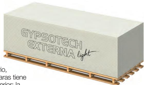
Placa de cemento aligerado con poliestireno, reforzada con fibra de vidrio, diseñada para ser aplicada en interior o exterior. Cada una de las dos caras tiene una composición diferente: la primera es lisa, para recibir el acabado interior; la segunda es rugosa, para recibir revocos y regularizadores.
