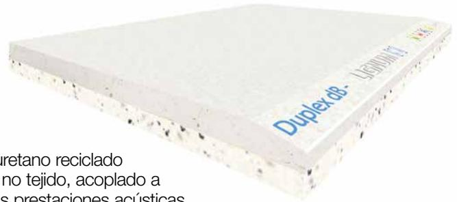
Placa GYPSOTECH® GyptoLIGNUM BA 13 con panel de poliuretano reciclado de 10 mm de espesor revestido por ambos lados con un textil no tejido, acoplado a su dorso, para soluciones de pequeñas dimensiones y elevadas prestaciones acústicas.
