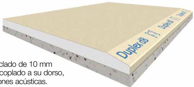
Placa GYPSOTECH® STD BA 13 con panel de poliuretano reciclado de 10 mm de espesor revestido por ambos lados con un textil no tejido, acoplado a su dorso, para soluciones de pequeñas dimensiones y elevadas prestaciones acústicas.
