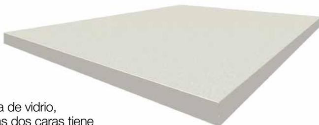
Placa de cemento aligerado con poliestireno, reforzada con fibra de vidrio, diseñada para ser aplicada en interior o exterior. Cada una de las dos caras tiene una composición diferente: la primera es lisa, para recibir el acabado interior; la segunda es rugosa, para recibir revocos y regularizadores.
