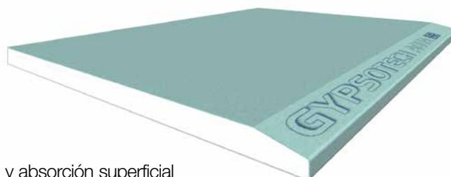
Placa de baja capacidad de absorción de agua (inferior al 10%) y absorción superficial (inferior a 220 g/m<sup>2</sup>) específica para ambientes con condiciones higrométricas particulares.
