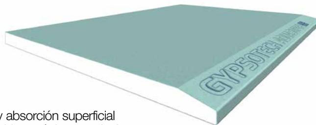
Placa de baja capacidad de absorción de agua (inferior al 5%) y absorción superficial (inferior a 180 g/m<sup>2</sup>) específica para ambientes con condiciones higrométricas particulares.
