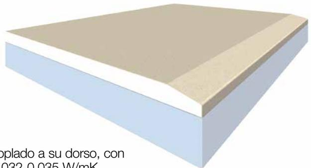
Placa de yeso laminado con panel de poliestireno extrusionado acoplado a su dorso, con densidad de 30 kg/m³ ± 3% y conductividad térmica lambda de 0,032-0,035 W/mK.
