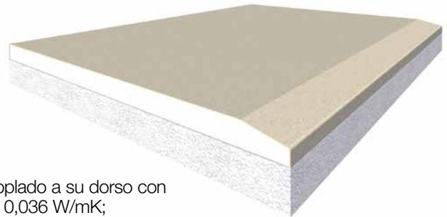
Placa de yeso laminado con panel de poliestireno expandido acoplado a su dorso con densidad de 15 kg/m³ ± 8% y conductividad térmica lambda de 0,036 W/mK;
