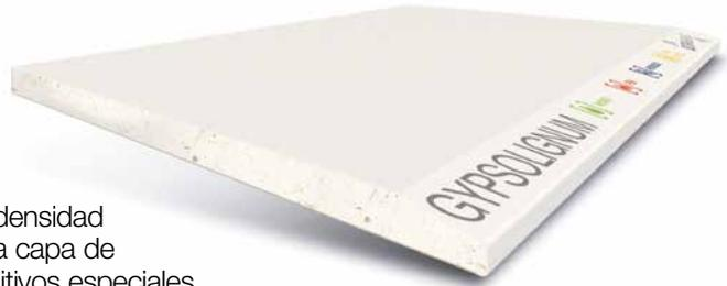
Placa especial diseñada para reunir varias particularidades; de densidad superior a 1000 kg/m<sup>3</sup>. GypsoLIGNUM esta constituida por una capa de celulosa externa de alta resistencia y una masa de yeso con aditivos especiales en el núcleo de yeso: fibra de vidrio, vermiculita, hidrófugos y harina de madera de granulometría diferenciada.
