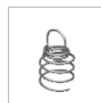
A - Fijación en espiral a 15 cm. de los cantos
